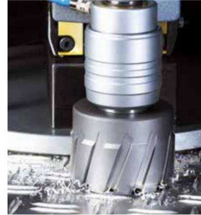
Корончатые сверла BDS изготавливаются на современных шлифовальных обрабатывающих центрах с ЧПУ. Это гарантирует постоянный профиль режущих кромок, качество и производительность всех сверлильных инструментов из ассортимента BDS.
