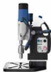
Мобильное зажимное приспособление MobilCLAMP позволяет расширить область применения сверлильного станка на магнитном основании на монтажной площадке и в мастерской. Для этого сверлильный станок устанавливается на опорную поверхность и включается. Детали надежно крепятся в призматических тисках, в итоге вы без особых затрат очень быстро получите настольный сверлильный станок.
