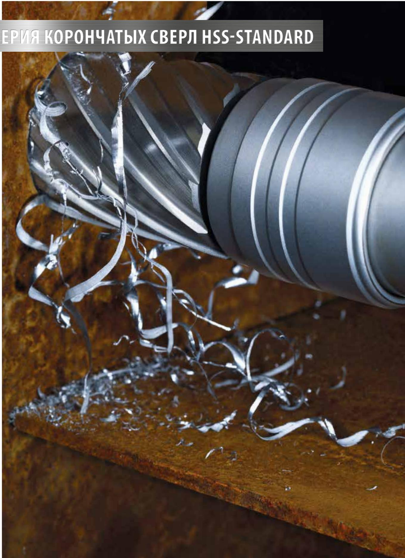
Базовый ассортимент корончатых сверл для профессионального применения. Полностью шлифованные корончатые сверла из быстрорежущей стали повышенной стойкости, изготовленные на современных шлифовальных обрабатывающих центрах с ЧПУ, с хорошим отводом стружки. Сверление без больших физических нагрузок. Для горизонтального сверления BDS рекомендует высококачественный смазочный спрей BDS 5200.
