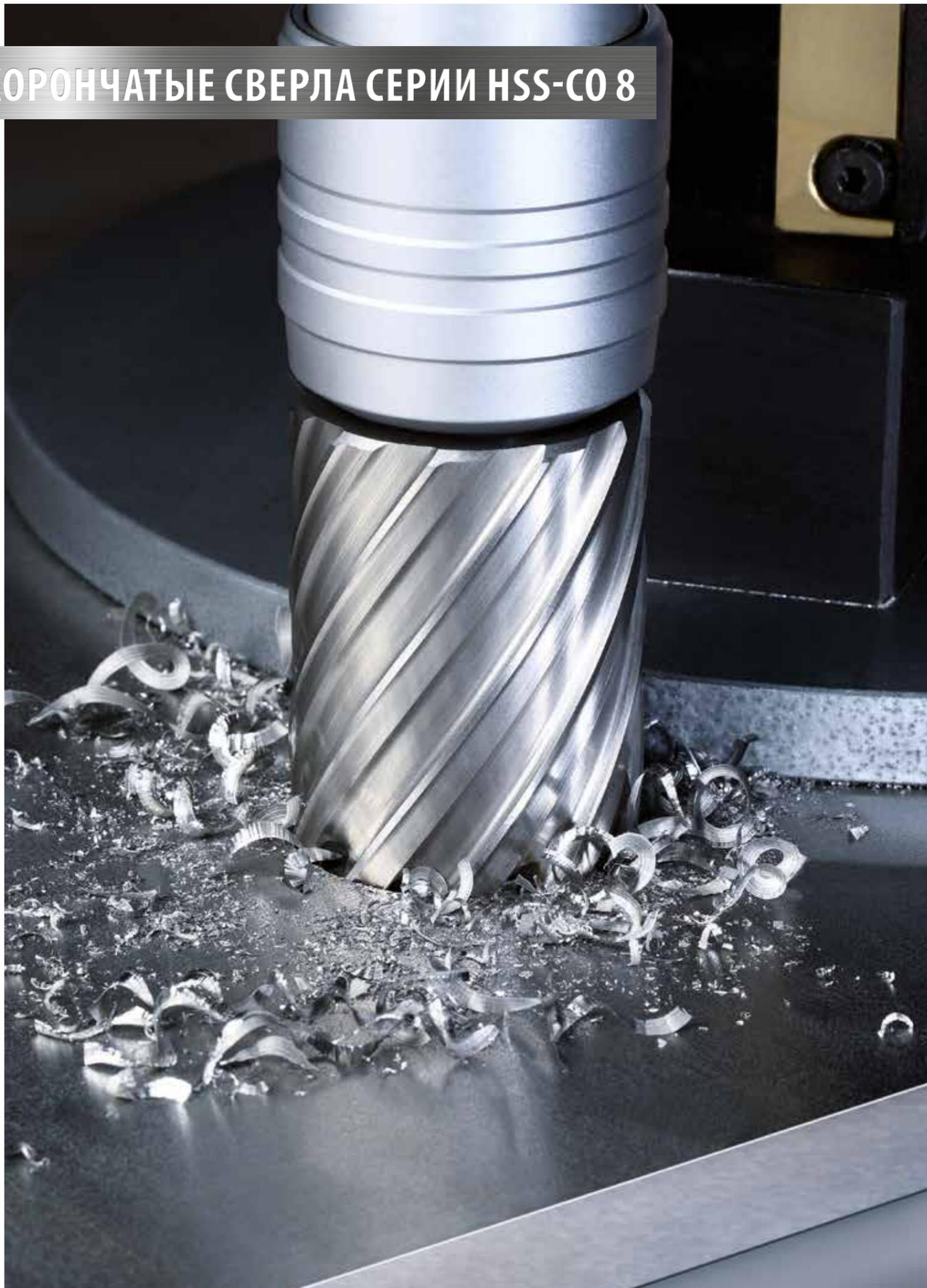
Сверла этой серии отличаются высокой жаропрочностью и износостойкостью. В комбинации с оснащенной системой управления частотой вращения станками для корончатого сверления на магнитном основании фирмы BDS они прекрасно подходят для обработки мелкозернистых сталей и нержавеющей материала. Фирма BDS рекомендует для обработки нержавеющей стали использовать смазочно-охлаждающую жидкость BDS 5000.
