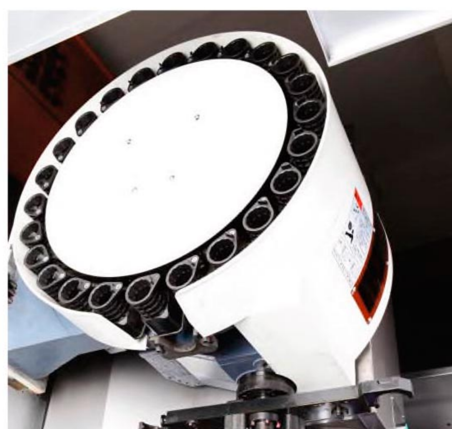
Устройство автоматической смены инструмента с поворотным рычагом
